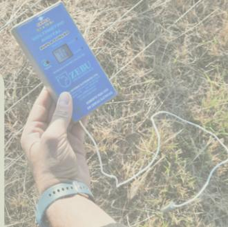
Os **Voltímetros Zebu** são utilizados para **medir voltagem (kV)**, ou seja, a carga de choque, possibilitando encontrar eventuais falhas no sistema.
