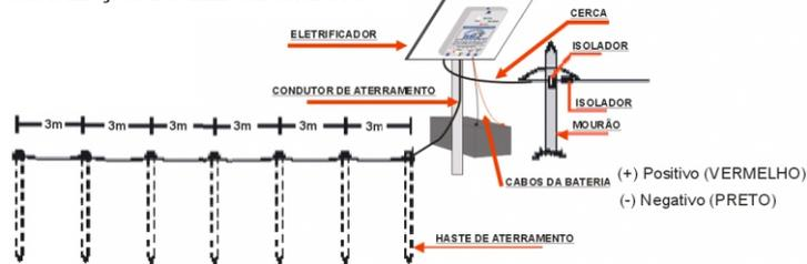
**Atenção!** A instalação da cerca elétrica deve ser realizada de acordo com as determinações presentes na norma ABNT NBR EC 60335-2-76;
