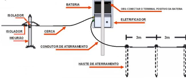
**Atenção!** A instalação da cerca elétrica deve ser realizada de acordo com as determinações presentes na norma ABNT NBR EC 60335-2-76; Antes de utilizar o eletrificador, conectar o Terminal Positivo da Bateria.
