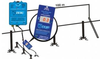
Ligue o eletrificador e em seguida utilize um voltímetro digital, crave a haste de metal do voltímetro no solo e pendure o voltímetro pelo gancho no cabo do terra. Caso a leitura do voltímetro for superior a 0,3kV, torna-se necessário instalar mais uma haste, enterrando-a a três metros de distância da primeira. O teste deve ser repetido até que a tensão medida não seja superior a 0,3kV.
